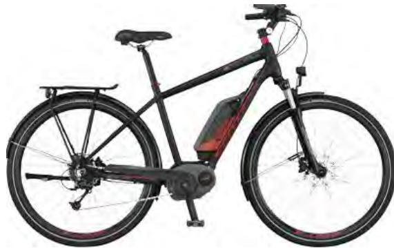
Vélo avec moteur dans le pédalier (image : www.scott-sports.com )
